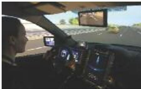
Tester avec le simulateur Roads comment le conducteur réagit aux alarmes pour reprendre la main sur le véhicule.
