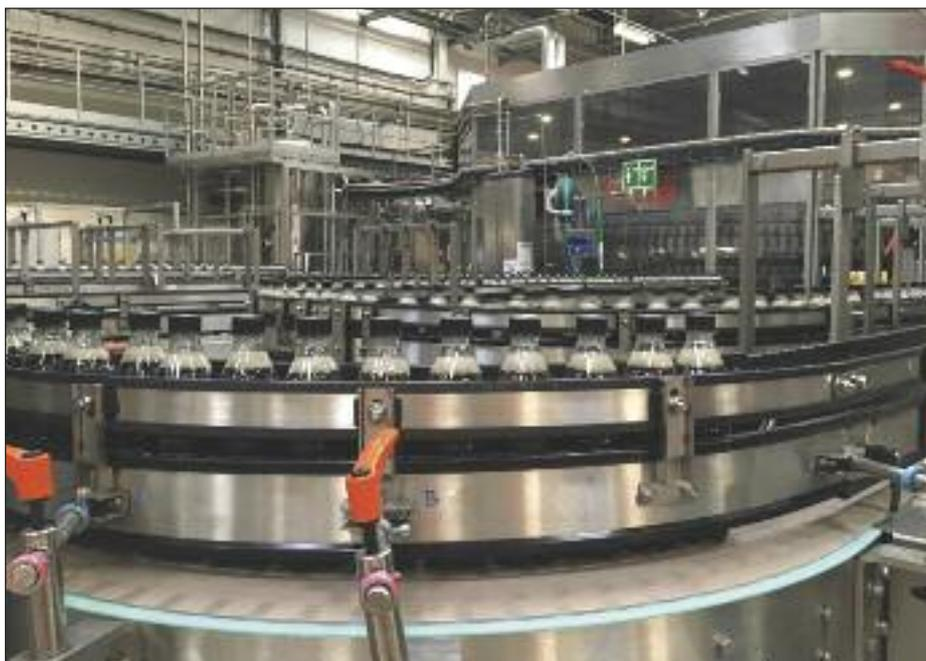
L'usine de Castanet-Tolosan a une capacité de 36 000 bouteilles de 0,50 litres par heure.
